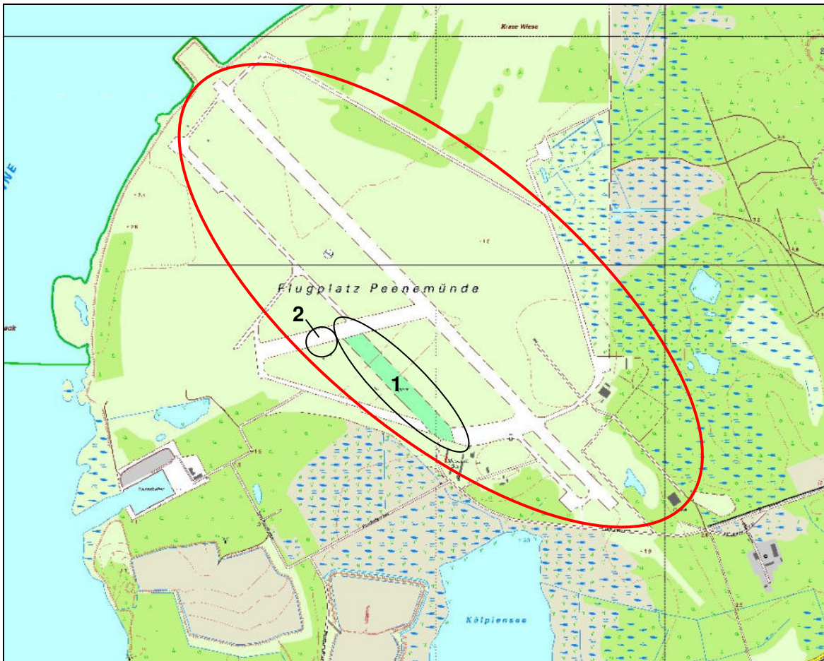
Abbildung 12: nachgewiesene Grundwasserverunreinigungen (rot – Vorhaben, 1 – Vorstartlinie, Haupttanklager, 2 – Zwischentanklager 1 mit Leichtflüssigkeitsabscheider)
