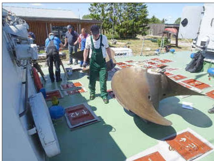
Die Bodenplatten der Kommandobrücke wurden auf den neuen Belag geklebt
