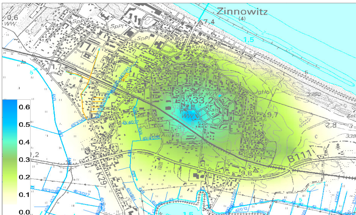
Abbildung 6: Anstieg des mittleren Grundwasserspiegels [m] infolge der Entnahmeverringering der Wasserfassung Zinnowitz
